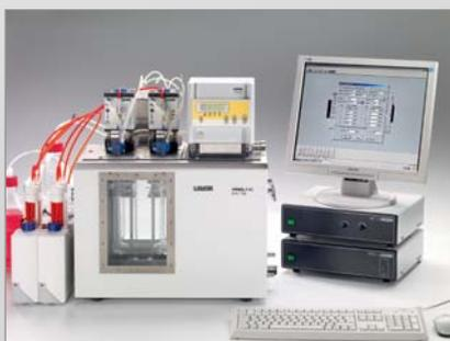
Automatische Bestimmung der intrinsischen Viskosität bei 135 °C für Polyolefine etc.
