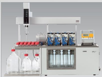
Vollautomatische Messung von Viskositätskennzahlen in der Produktionskontrolle
